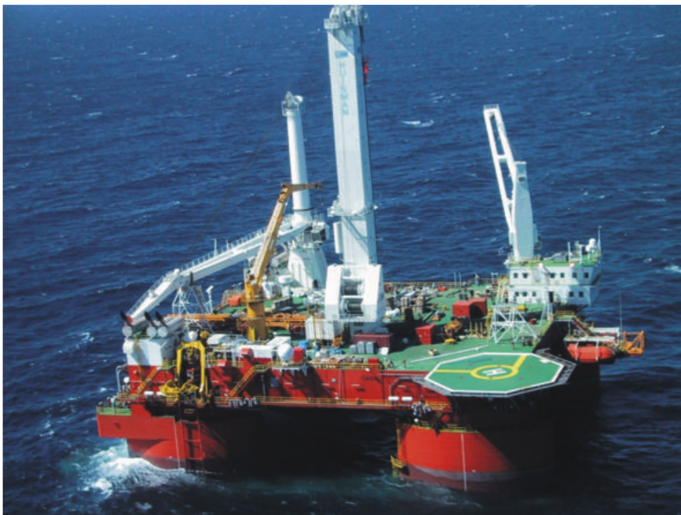
Figuur 2, Boorschip Q4000 met Passief Deining Compensatie systeem
